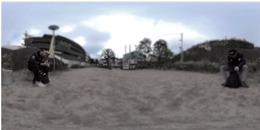
図5：エクイレクタングラー形式。正距円筒図法。球体を平面に変換し全天球イメージとして記録する方法の1つ。
