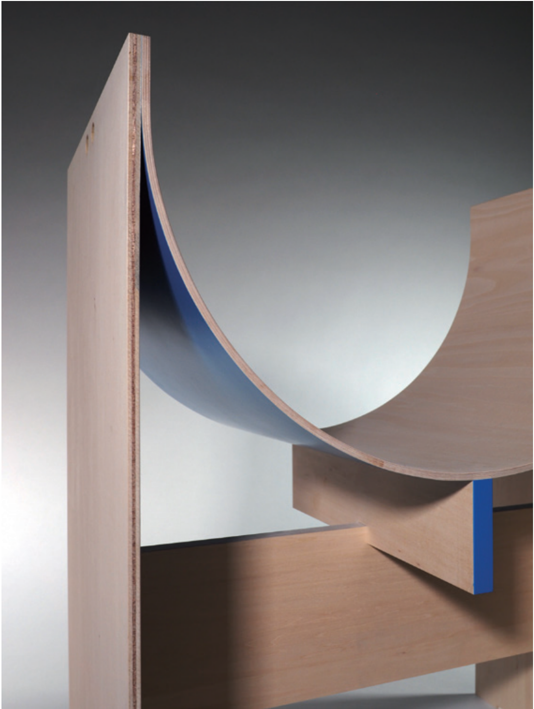
アルミ製との大きな違いは、座面下の部材を相欠きにしないと揺れが治らなかったこと
